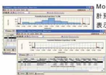
Monte Carlo分析是對您的電路設計預先做良率的分析並用統計圖來表示。在Monte Carlo的分析裡會針對每個元件的參數及誤差範圍的設定用機率分佈方式來隨機的取樣並做分析？並且在每次模擬完後的統計的分析裡顯示特性值及其結果以計算良率。
