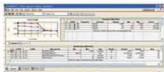
在Cadence® OrCAD® PSpice® Advanced Analysis裡頭的Optimizer可做類比電路和系統的分析。讓您不用一顆一顆去更換零件數值而會自動微調以求得符合規格和限制的最適當零件值。也可以設定不同的目的和限制條件讓Optimizer為算出其他規格的零件值。
