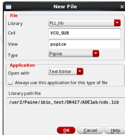
圖五、PSpice Cell View 設定
